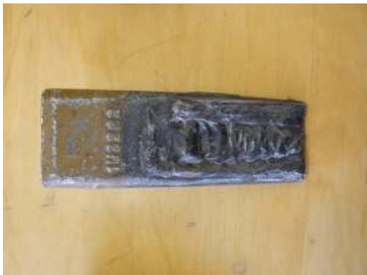
2.6 pav. Dantis aplydytas OK 83.50 markės elektrodais
