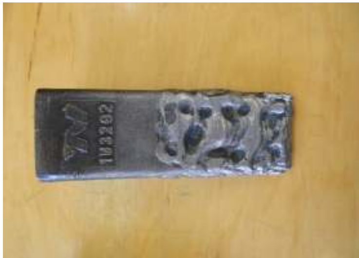
2.4 pav. Dantis aplydytas 677 markės elektrodais
