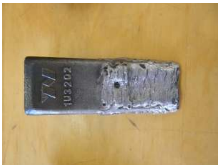
2.3 pav. Dantis aplydytas APL AV 60 markės elektrodais
