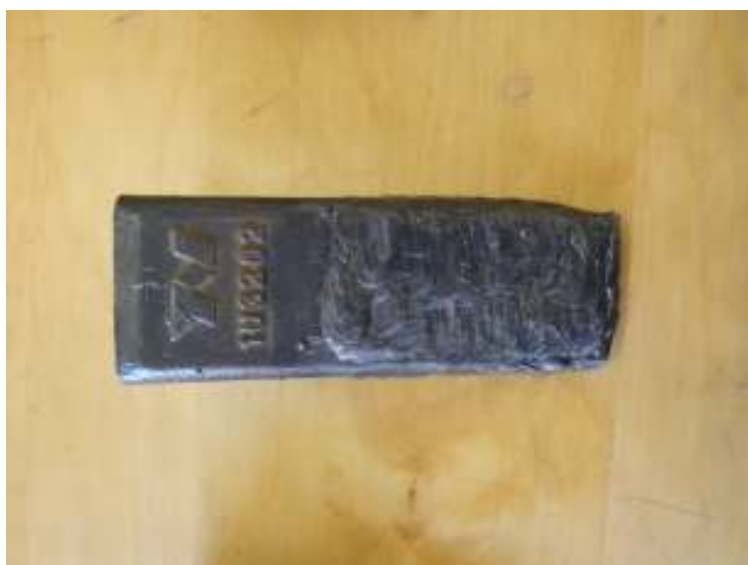
2.7 pav. Dantis aplydytas OK 84.52 markės elektrodais
