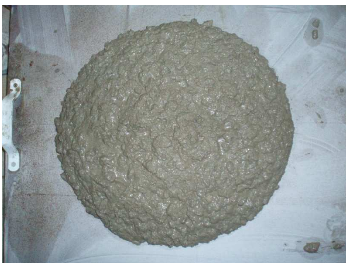
3.11 pav. Betono mišinio sklidumo bandymo atvejis
