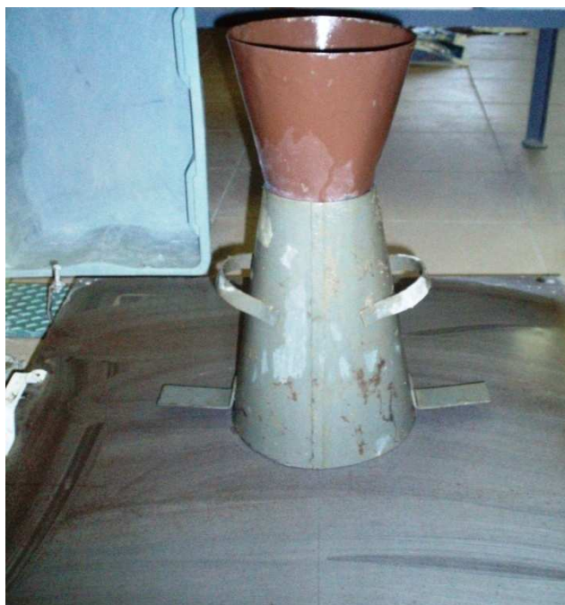
2.4 pav. Kratytuvas ir kūginė forma mišinio sklidumui nustatyti
