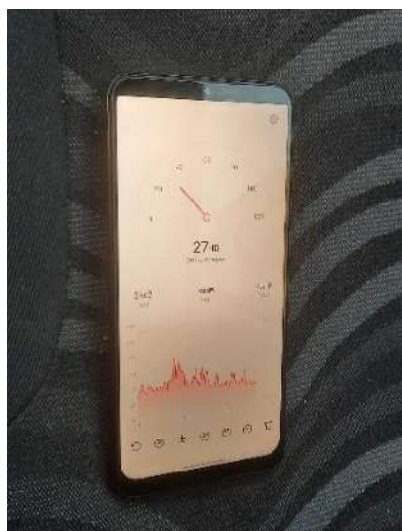
49 pav. Mobiliosios programėlės Sound Meter darbinis langas ir telefono vieta matavimo metu (autoriaus nuotraukos)
