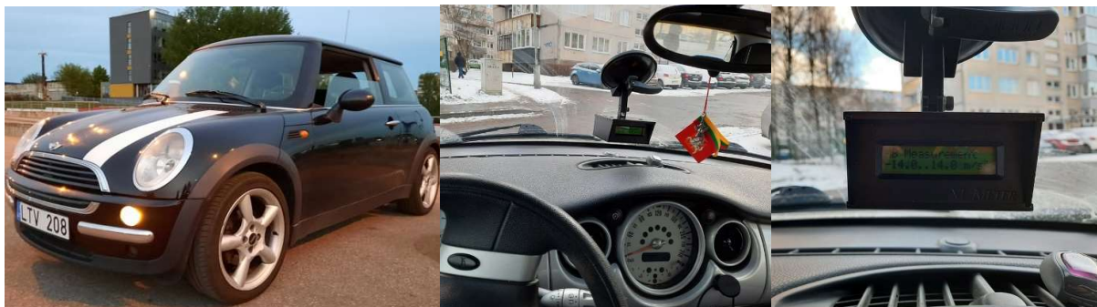
42 pav. Automobilis 2001 m. MINI ONE (R50 kėbulas) ir prietaiso XL Meter montavimo vieta automobilyje (autoriaus nuotraukos)
