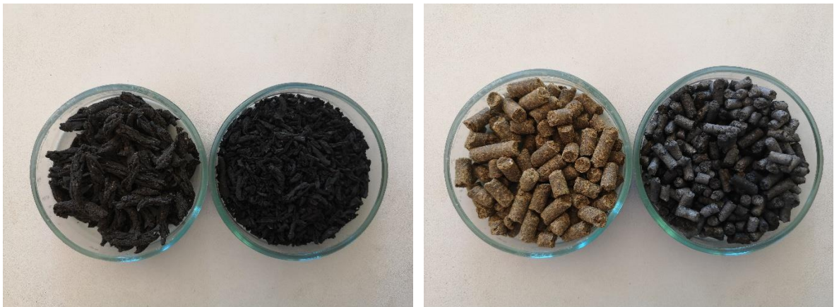
21 pav. Nuotekų dumblo žaliava – kairėje, 22 pav. Rapsų išspaudų žaliava – kairėje, bioanglis – dešinėje.
