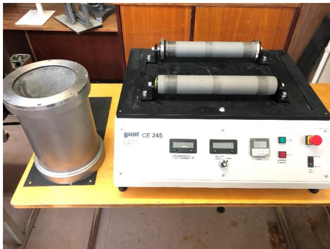
15 Pav. Malimo mašina GUNT Hamburg CE 245.
