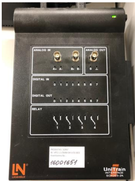
9 Pav. „UniTrain-I System SO4203-2A Interface“ eksperimentinė įranga.
