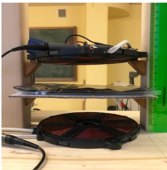
21 Pav. Feromagnetinės medžiagos išdėstymas matuojant įterpus ją tarp ričių.
