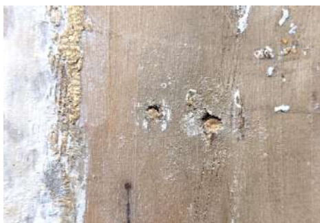
17 pav. Vaizdinėje paveikslo „Šv. Mikalojus“ [50] pusėje esantys medienos užpildai. Nuotraukoje matosi, kad užpildai susitraukė ir susidarė nedideli tarpeliai.
