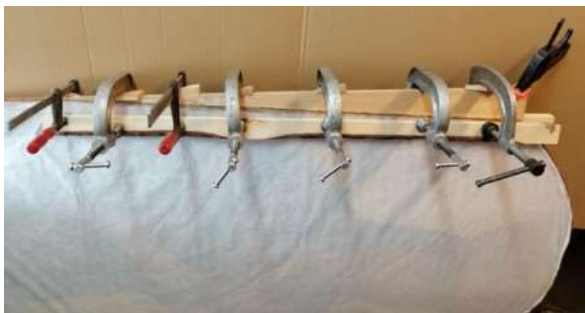
8 pav. Nuskeltos Krekenavos „Švč. Mergelės Marijos su Vaikeliu“ [48] paveiklo dalies atkūrimas, priklijuojant pušies medžio detalę. Nuotraukoje matomas kljavimo procesas, kai spaustuvais suveržiama klijuojama dalis. Nauja detalė taip pat tvirtinta mediniais kvadratiniais kaiščiais.
