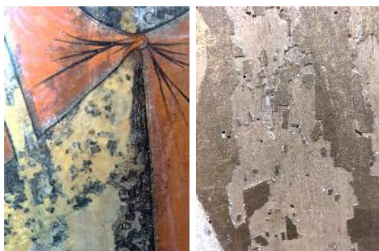
22 pav. Nuotraukose matomi padriki tapybos sluoksnio gabalėliai paveikslų, kurie praeityje buvo užklijuoti „profilaktiniu“ popieriumi ir su juo palikti ilgesniam laikui. Kairėje – „Šv. Arkangelo Mykolo“ [31] paveikslo fragmentas, dešinėje – „Šv. Mikalojaus“ [50] fono fragmentas.
