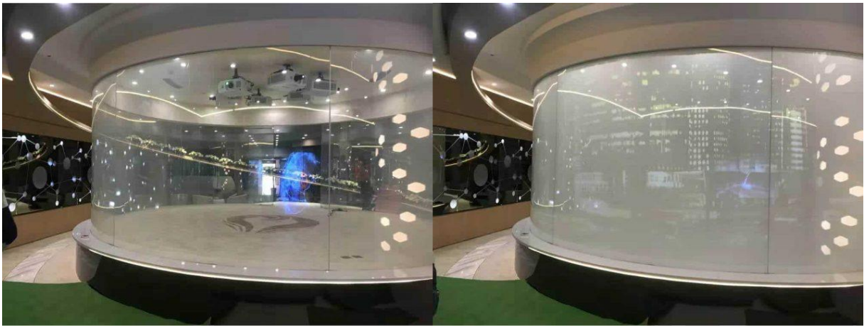
1.12 pav. Išmanusis stiklas (kairėje – įtampa įjungta, dešinėje – išjungta) (REV, n.d.)
