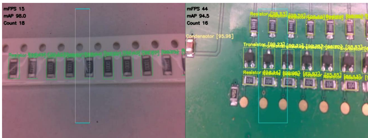
4.3 pav. Kadras iš rezistorių aptikimo ir skaičiavimo tyrimo su YOLOv4-tiny ir YOLOv4 detektoriais
