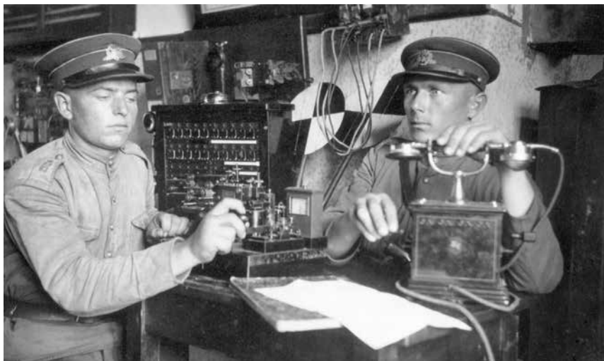
6 pav. Lietuvos kariuomenės 2-ojo ulonų kavalerijos pulko eilinis ir jaunesnysis puskarininkis prie telegrafo ir telefono aparatų. Toliau matyti 30 linijų komutatorius ir signaliniai skydeliai. 1935–1940 m. Autoriaus kolekcijos nuotrauka
