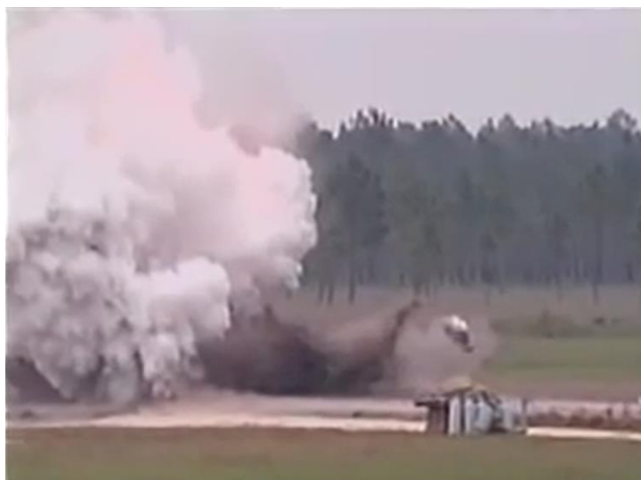
1.1 pav. Du kadrai iš videofilmo, vaizduojančio cilindrinio indo sprogimą: išorinio gaisro liepsnos kaitinamas indas ir suirusio indo skeveldros išmetimas [BLEVE Demonstration, You Tube, 2009]
