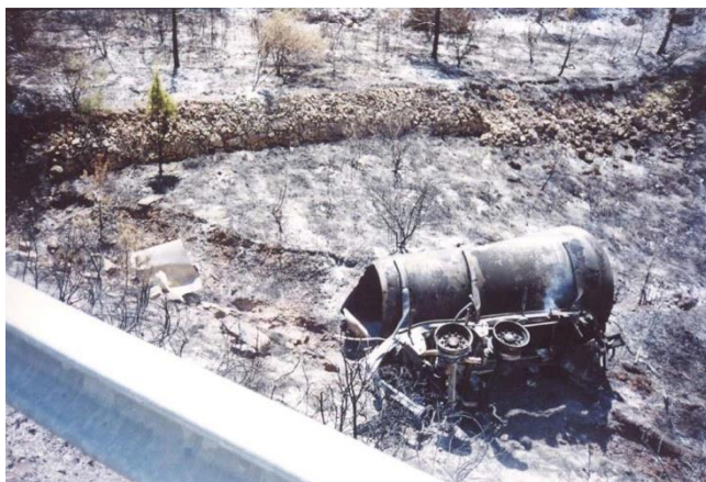
1.9 pav. Sprogimo išmėtytos priekinė, vidurinė ir galinė cisternos dalys (iš viršaus į apačią) (Planas-Cuchi et al., 2004)
