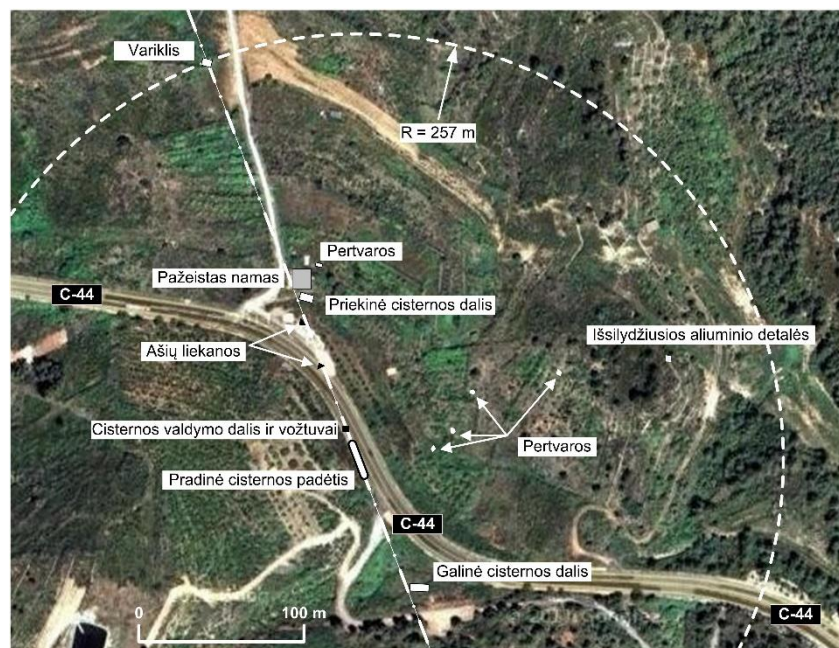
1.10 pav. Automobilinės cisternos dalių išsidėstymas po sprogimo (Planas-Cuchi et al., 2004)
