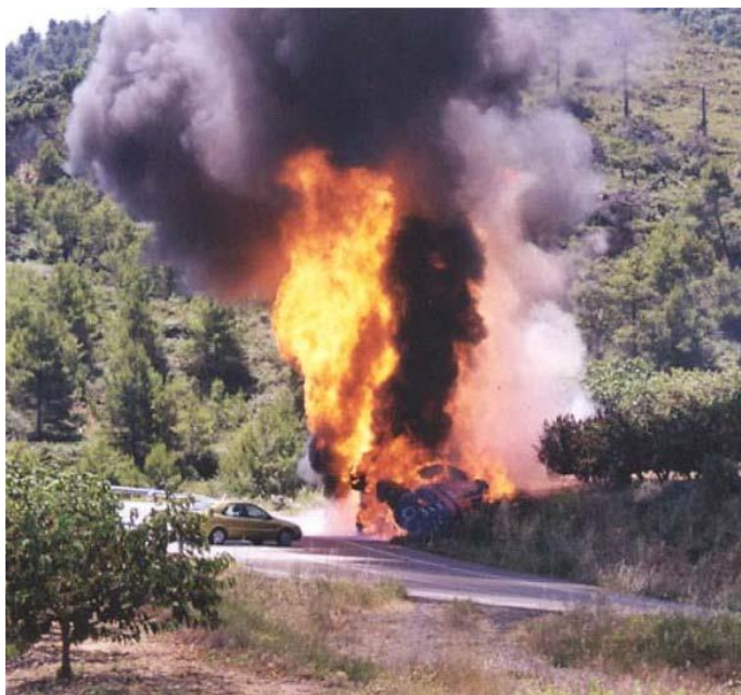
1.8 pav. Deganti automobilinė cisterna, nufotografuota 2 min po kelio avarijos ir maždaug 18 min iki sprogo (Planas-Cuchi et al., 2004)
