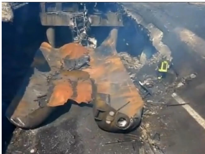
1.6 pav. Dujinės cisternos sproginimo metu susiformavusi indo korpuso liekana, nuo kurios neatplyšo ir nebuvo išmestos jo dalys (Puerto Lumbrero ir Granados SND autocisternos avarija, 2012 m.)
