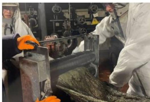
Рис. 2. Регенерация сорбционного полотнища с использованием валкового устройства
