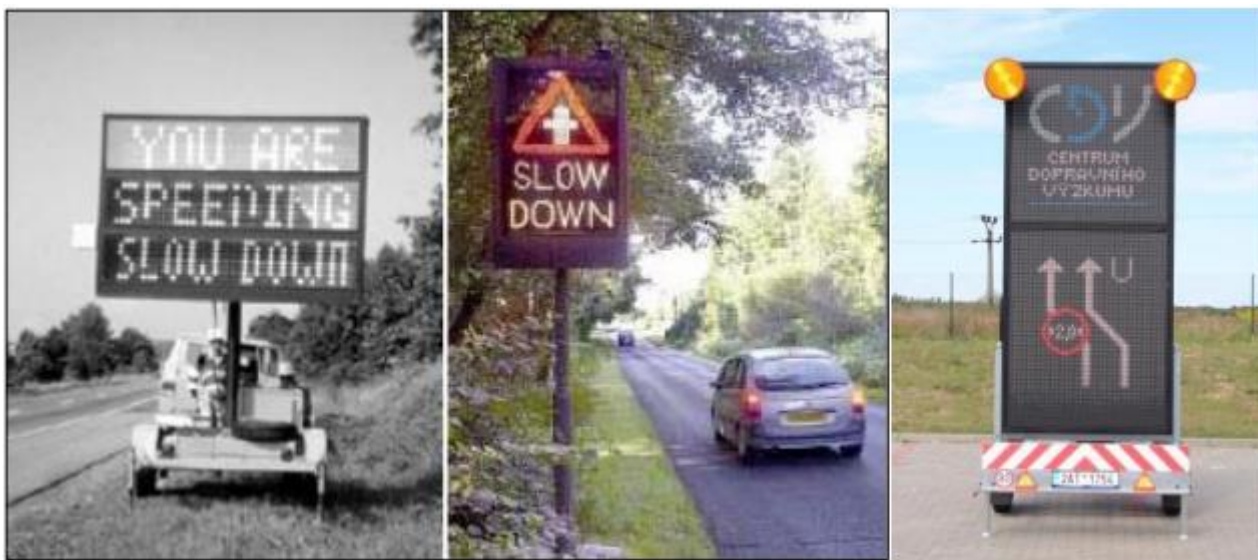
2.35 pav. Kintamos informacijos švieslentės ( www.workzonesafety.org )
