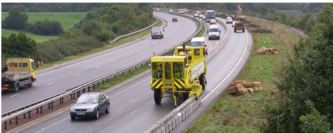
2.33 pav. Kintamas eismo juostų atskyrimas ( www.barriersystemsinc.com )
