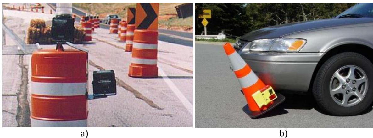
2.37 pav. Garsą skleidžiančios priemonės (Wang et al. 2011)
