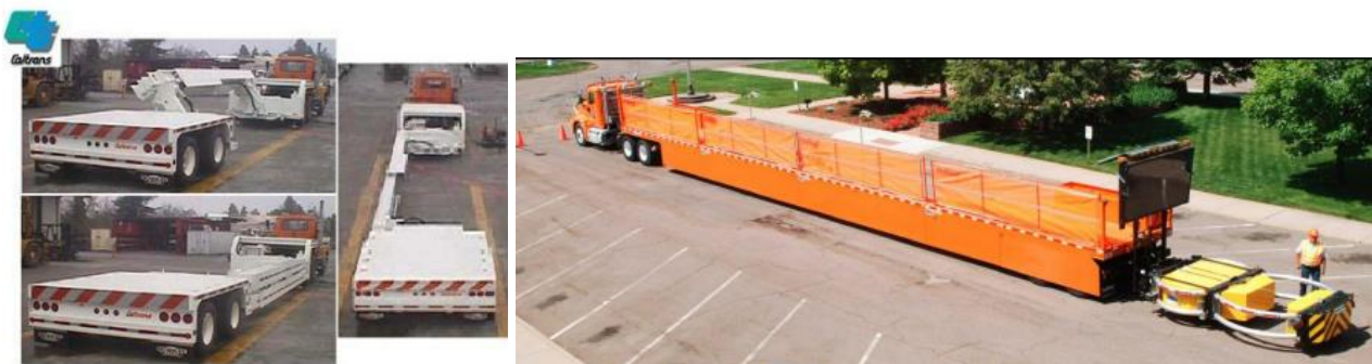
2.39 pav. Darbo zonos aptvėrimas (Wang et al. 2011)
