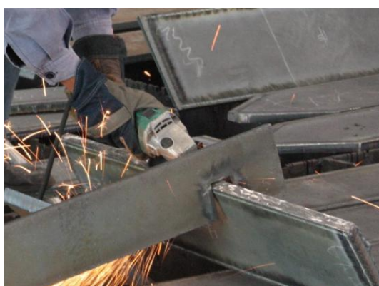
17 pav. Rankinis šlifavimas (kairėje) ir kraštų apvalinimo mašina (dešinėje) [42]
