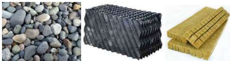
1.11 pav. Laistomųjų filtrų užpildai: a) akmenys; b) plastiko modulis (Cross flow...2015); c) akmens vata (Rockwool Hydroponics...2015)
