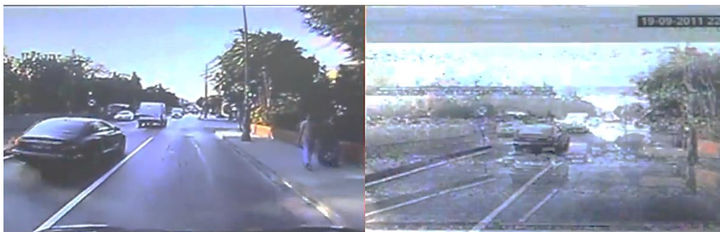
11 pav. Nuotolinio vaizdo perdavimo palyginimas: a) skaitmeninis signalas; b) analoginis signalas
