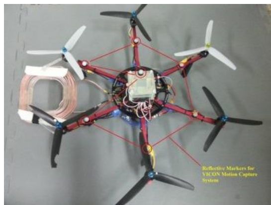
6 pav. Skraidantis robotas su akumulatoriaus bevielio parkovimo sistema [2]
