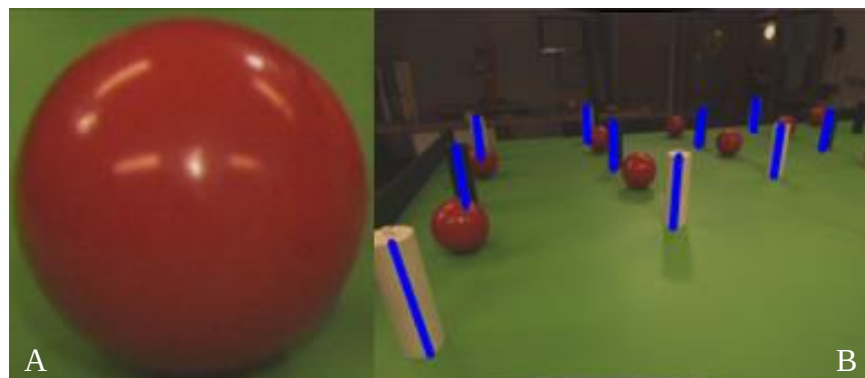
1 pav. Objektų atpažinimas: a) kai rutulio paviršius yra blizgantis; b) atpažinti cilindriniai objektai pažymėti mėlyna linija [23]
