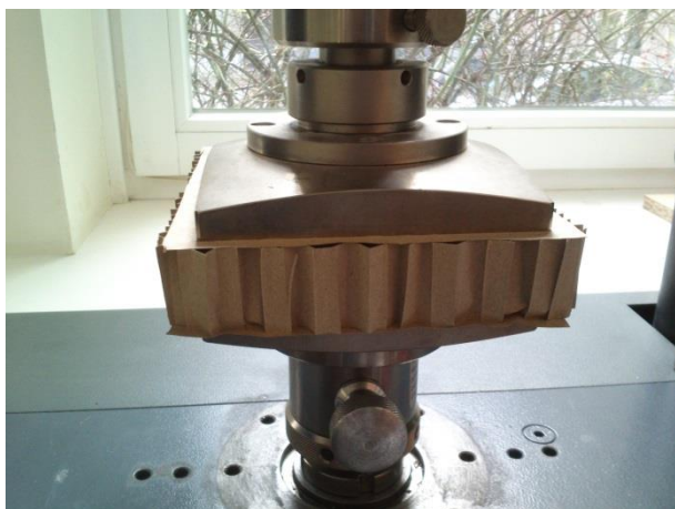
52 pav. Laminuoto korio gniuždymo pradžia
