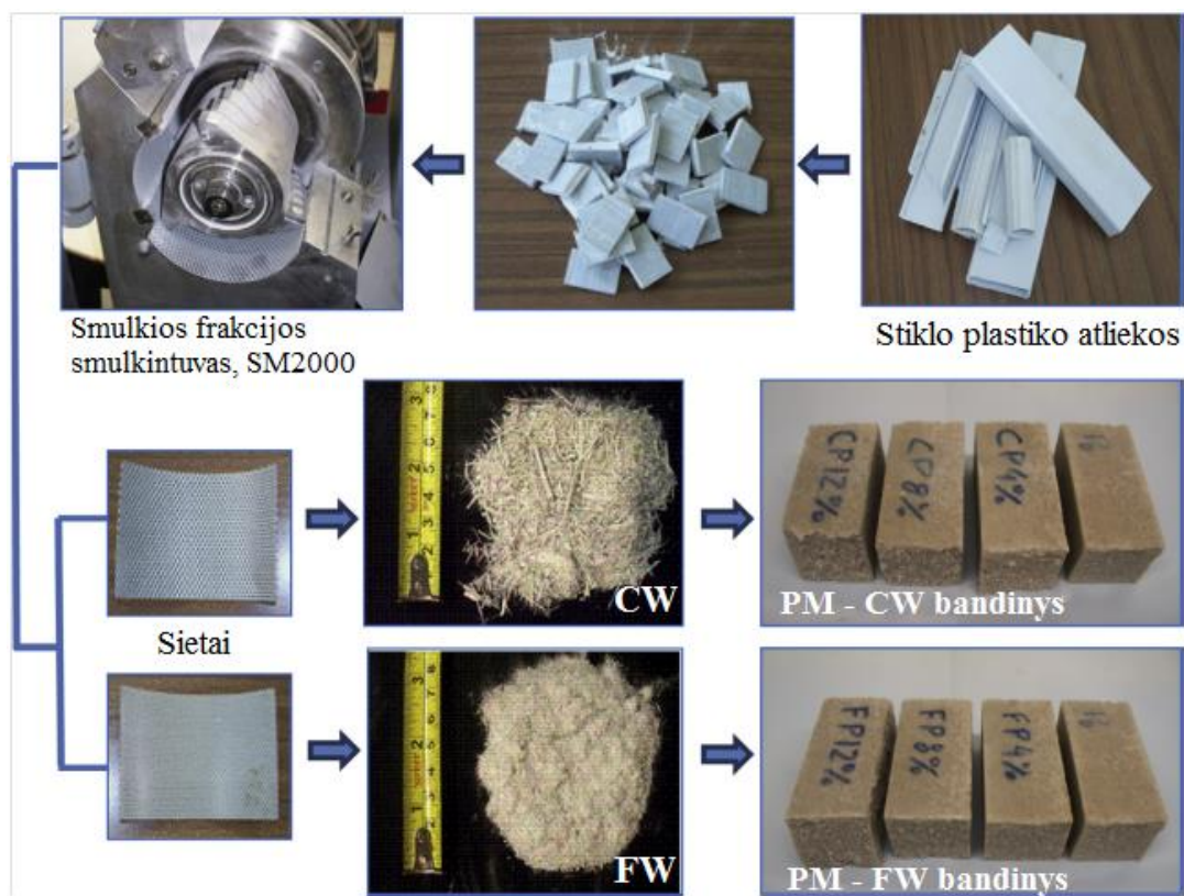
15 pav. Stiklo plastiko dalelių (PM) perdirbimo rezultatai, po mechaninio perdirbimo, naudojant CW ir FW susmulkintas daleles (Meira Castro A. C. ir kt. 2013)
