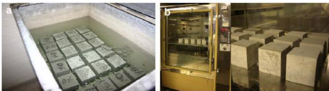
1 pav. Betono formavimas naudojant stiklo plastiko atliekų miltelius: a) vandenyje, b) krosnyje (P. Asokan et al. 2009)
