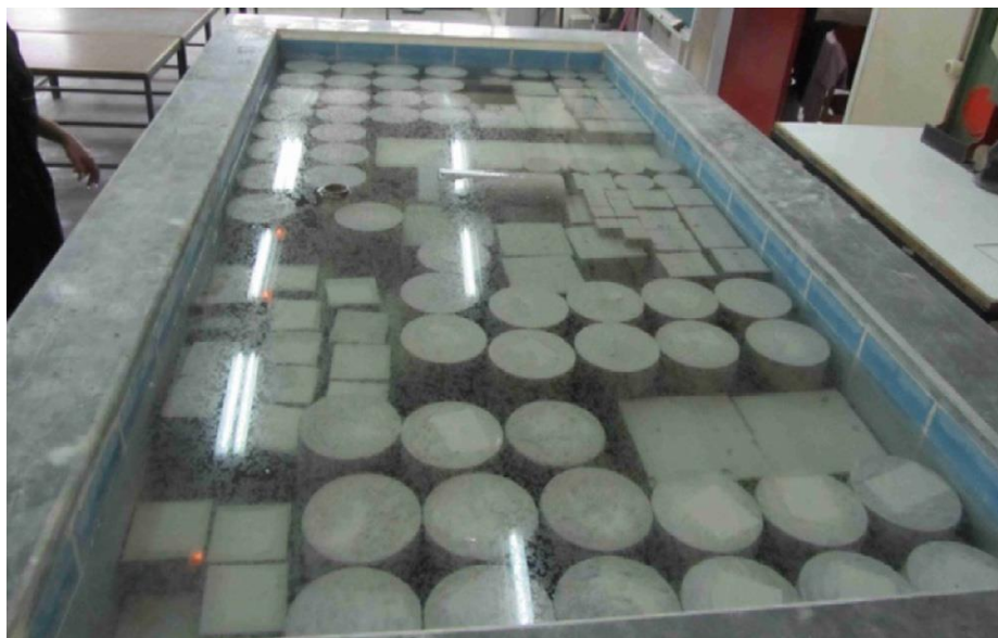
9 pav. Vandens rezervuaras su kubo ir cilindro formos bandiniais (Rahmani E. ir kt. 2013)
