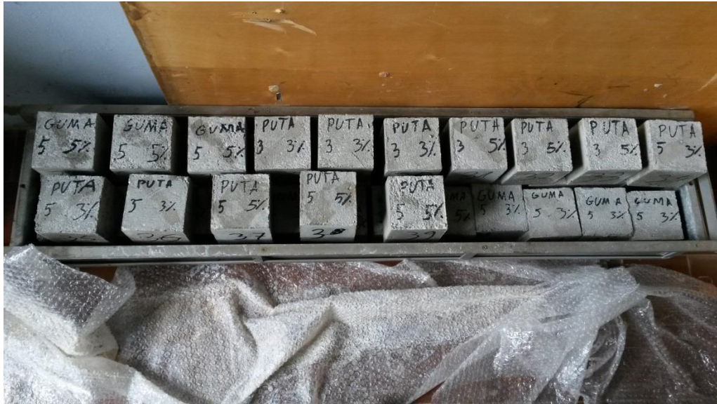
28 pav. 100 x 100 x 100 mm kubo formos bandiniai su antrinių žaliavų užpildais
