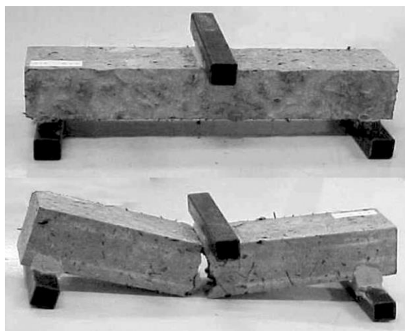
8 pav. BMGP bandiniai ( 5 \times 5 \times 25 \text{ cm}^3 ) prieš po ir po bandymo lenkiant (Gavrilov, J. ir Sivilevičiu, H., 2011)
