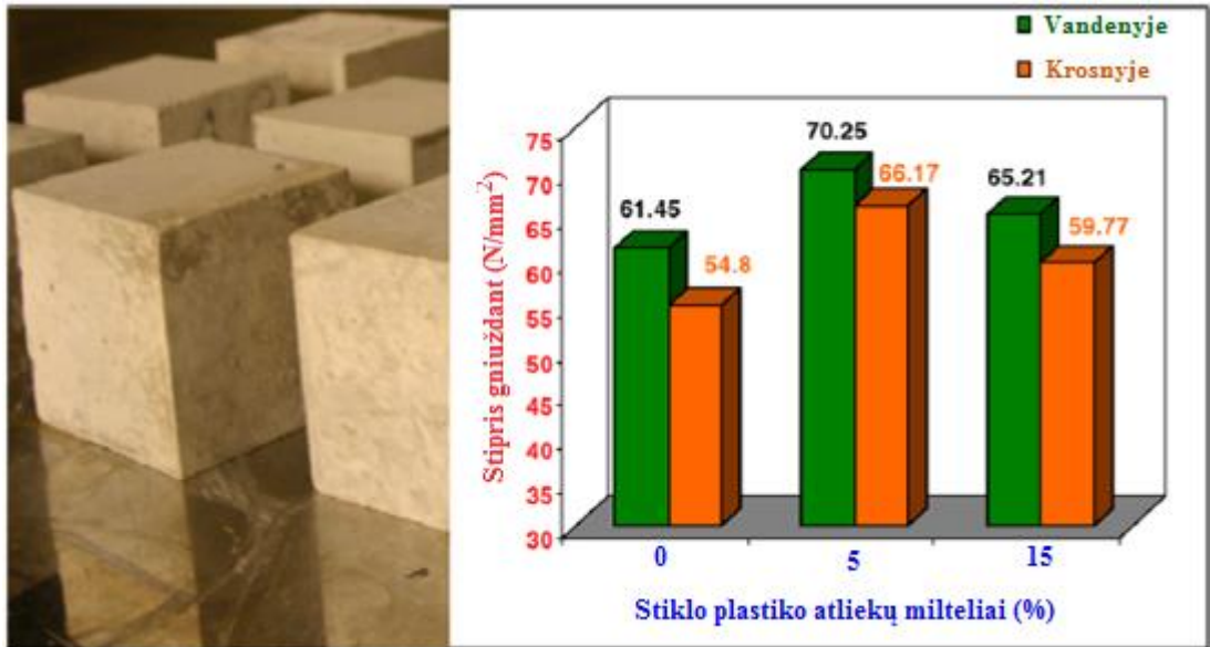
2 pav. Betono gniuždymas, stiklo plastiko atliekų miltelių poveikis procentais (P. Asokan et al. 2010)
