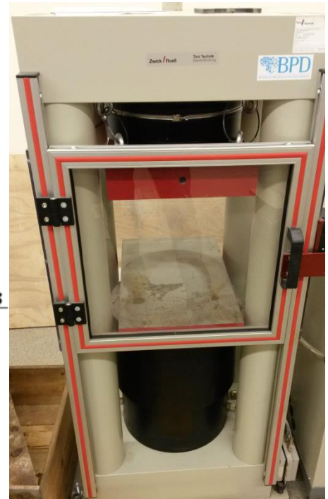
20 pav. Hidraulinė gniuždymo mašina Zwick/Roell Z3000
