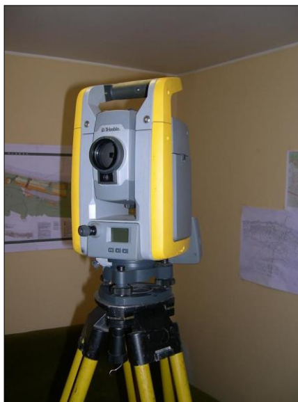
30 pav. Trimble S6 elektroninis tacheometras
