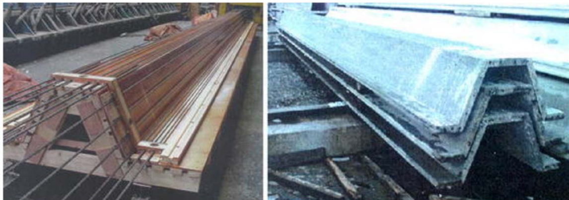
5 pav. HPFRC tipo gelžbetoninės spraustasielės elementai
