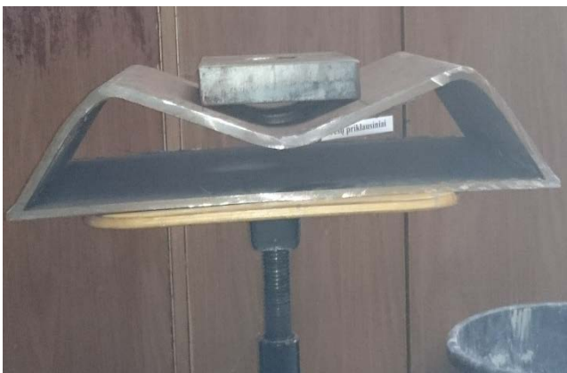
32 pav. Suiręs laboratorinis bandinys (a) ir skaitmeninio modelio deformacijos (b)
