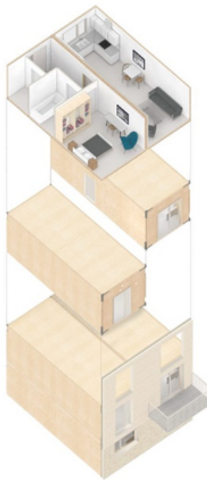
11 pav. Tūriniai surenkamieji moduliai, fragmentas (Treehugger, 2018)
