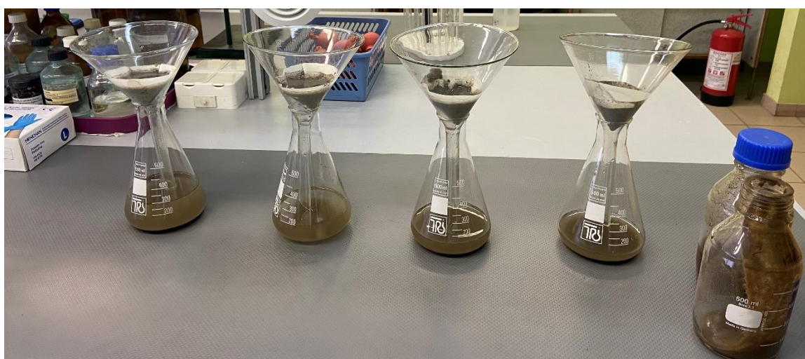
2.6 pav. Dirvožemio kelių mėginių atskyrimas nuo tirpalo filtruojant
