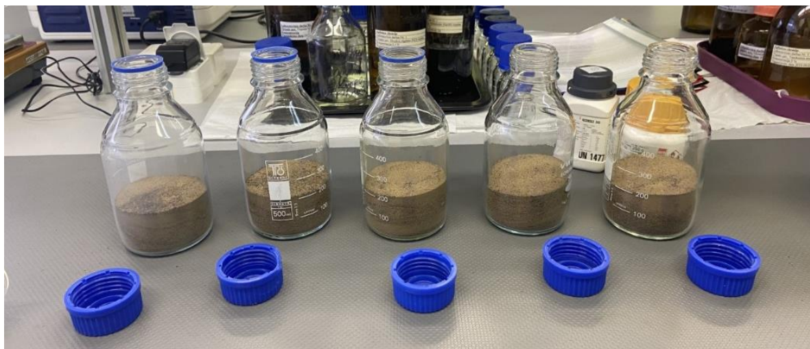
2.5 pav. Dirvožemio mėginių paruošimas sunkiųjų metalų įterpimui
