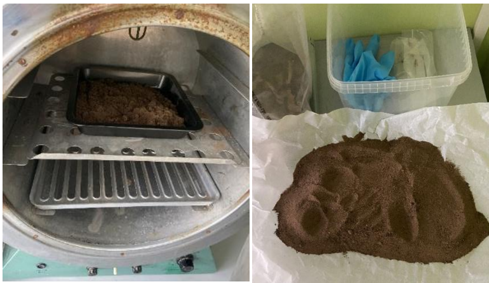
2.2 pav. Dirvožemio džiovinimas džiovintame krosnyje
