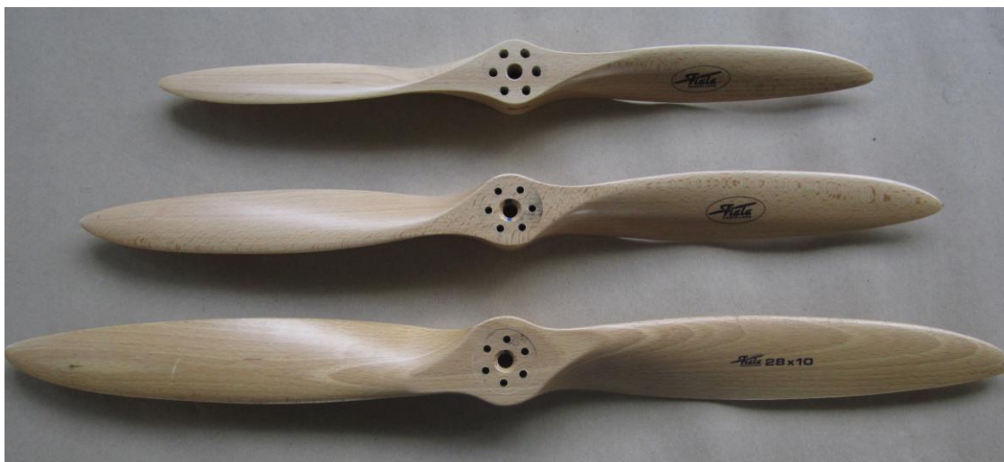
62 pav. Dviejų menčių 20“x23, 24“x16 ir 28“x10 propeleriai
