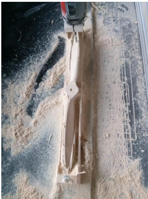
58 pav. 20"x23 propeleris frezavimo metu
