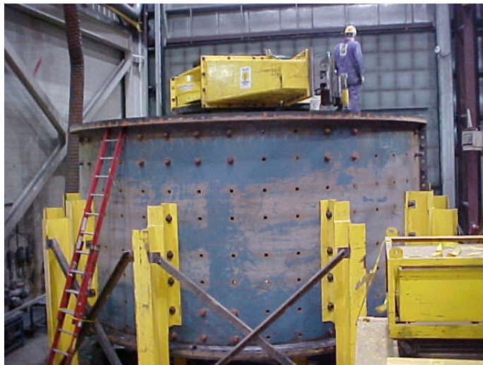
1.5 pav. Rutulinio malūno cilindro sekcijos flanšo paviršiaus frezavimas
