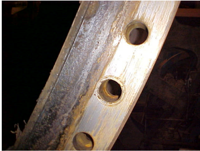
1.4 pav. Erozijos pažeistas rutulinio malūno flanšinės jungties paviršius
