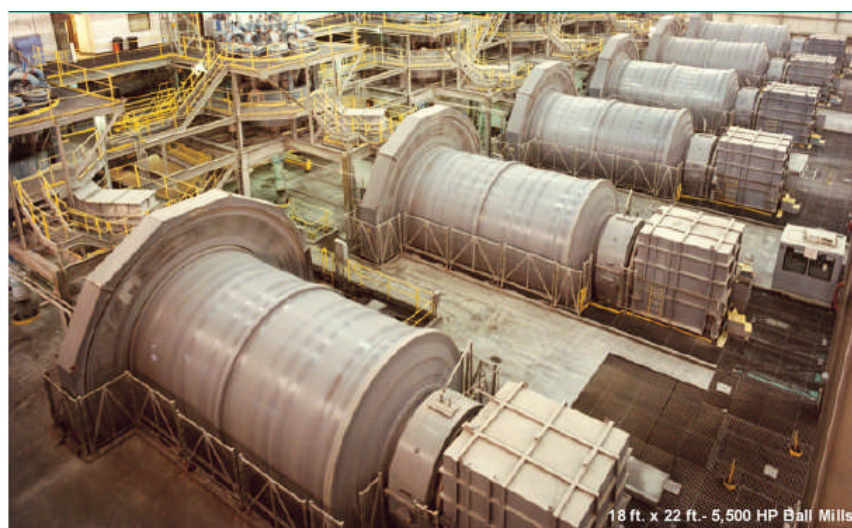
1.2 pav. Rutulinių malūnų baterija uolienų apdirbimo gamykloje
