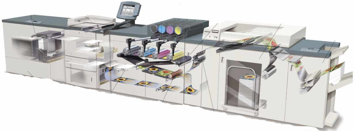
1.10 pav. „Xerox DocuColor 5000“ elektrofotografinės spaudos mašinos bendras vaizdas
