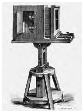
b) Fotoaparatas su keturiais objektyvais portretinėms vizitinio formato nuotraukoms
