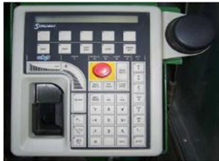
1 pav. Tipiškas nešiojamas industrinių robotų programavimo, valdymo įrenginys [1]
