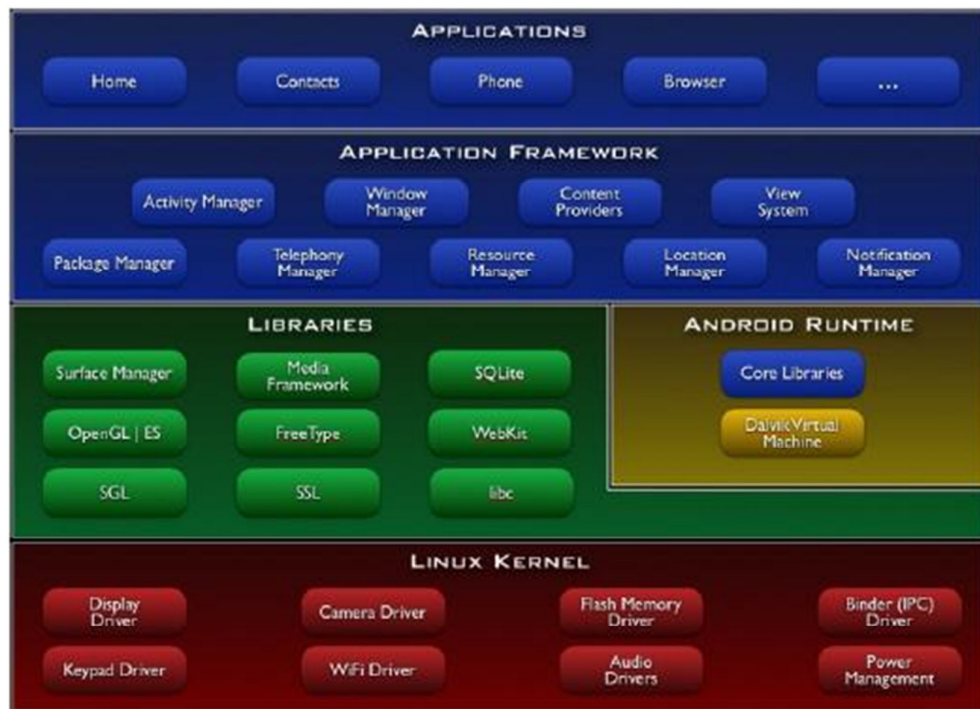
18 pav. Android operacinės sistemos architektūra [4]
