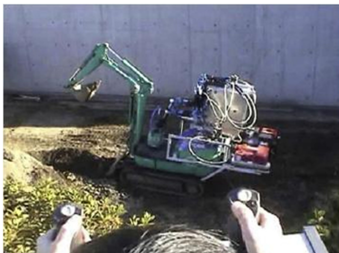
8 pav. Nuotolinis roboto (ekskavatoriaus) valdymas [24]
