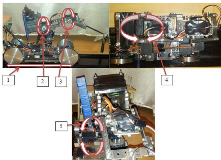
24 pav. Roboto manipulatoriaus prototipas: 1 – slenkamasis judėjimas; 2 – sukamasis judėjimas; 3 – sukamasis judėjimas; 4 – sukamasis judėjimas; 5 – sukamasis judėjimas
