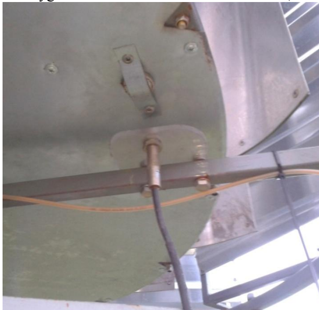
2.24 pav. Magnetinis jutiklis sparnuotės apsisukimams skaičiuoti (nuotrauka autoriaus, 2013)
