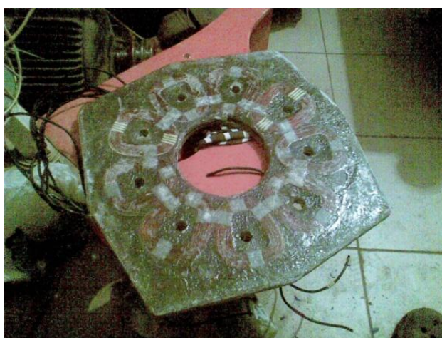
2.7 pav. Generatoriaus apvijų, statorius (nuotrauka autoriaus, 2013)
