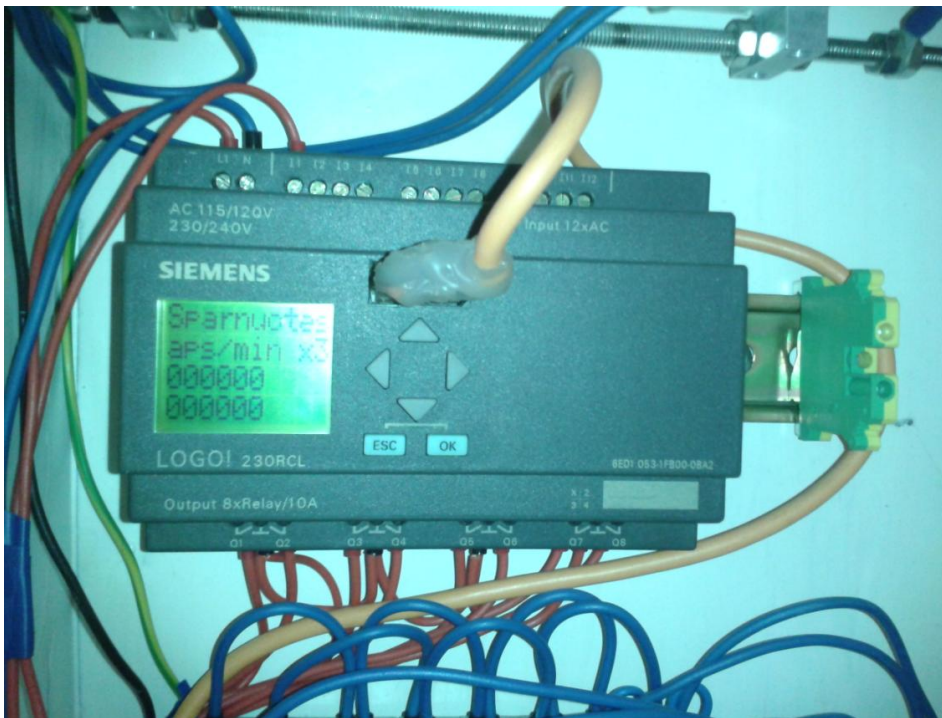
2.21 pav. Siemens Logo valdiklis apkrovos parinkimui ir sukimosi greičiui stebėti (nuotrauka autoriaus, 2013)
