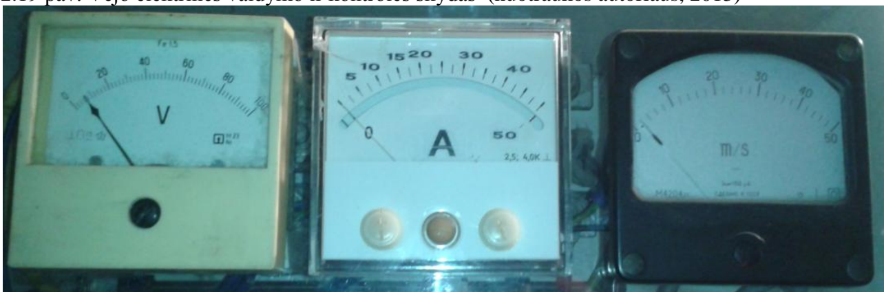
2.20 pav. Vėjo elektrinės stebėjimo elementai: voltmetro, ampermetras, anemometras (nuotrauka autoriaus, 2013)
