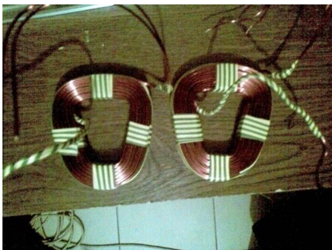
2.6 pav. Generatoriaus statoriaus ritės (nuotrauka autoriaus, 2013)
