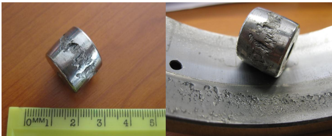
5.10 pav. 26D guolio defektas išoriniame žiede (aut. nuotrauka)
