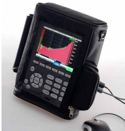
1.23 pav. Virpesių matavimo prietaisas CoCo – 80 (GMR – solutions [interaktyvus])
