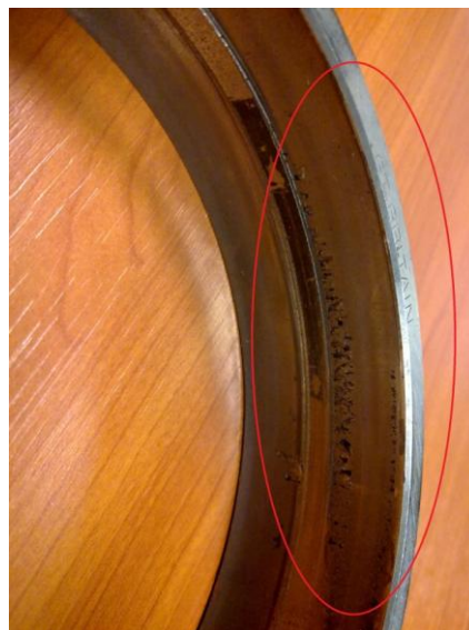
5.8 pav. 12K guolio defektas išoriniame žiede (autoriaus nuotr.)
