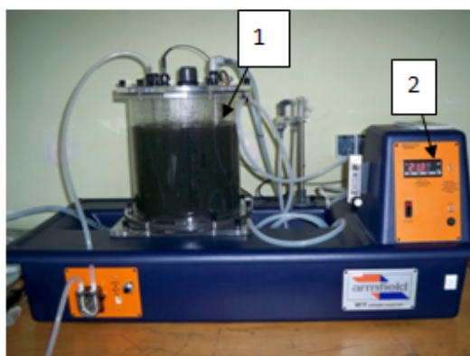
1 pav. Aerobinio dumblo stabilizavimo eksperimentinis stendas
