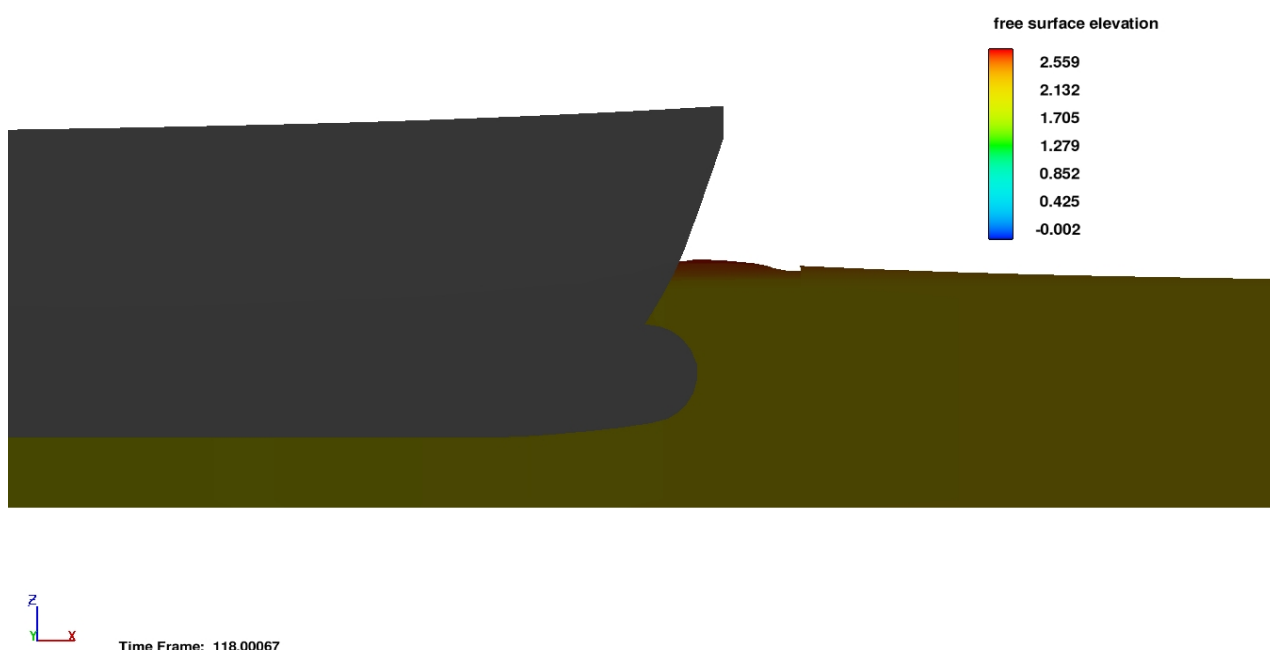
29 pav. Tiriamas laivas SSD programoje baseine 3,48 m/s
