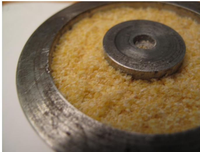
4.5 pav. Sutankintos dalelės po bandymo.
