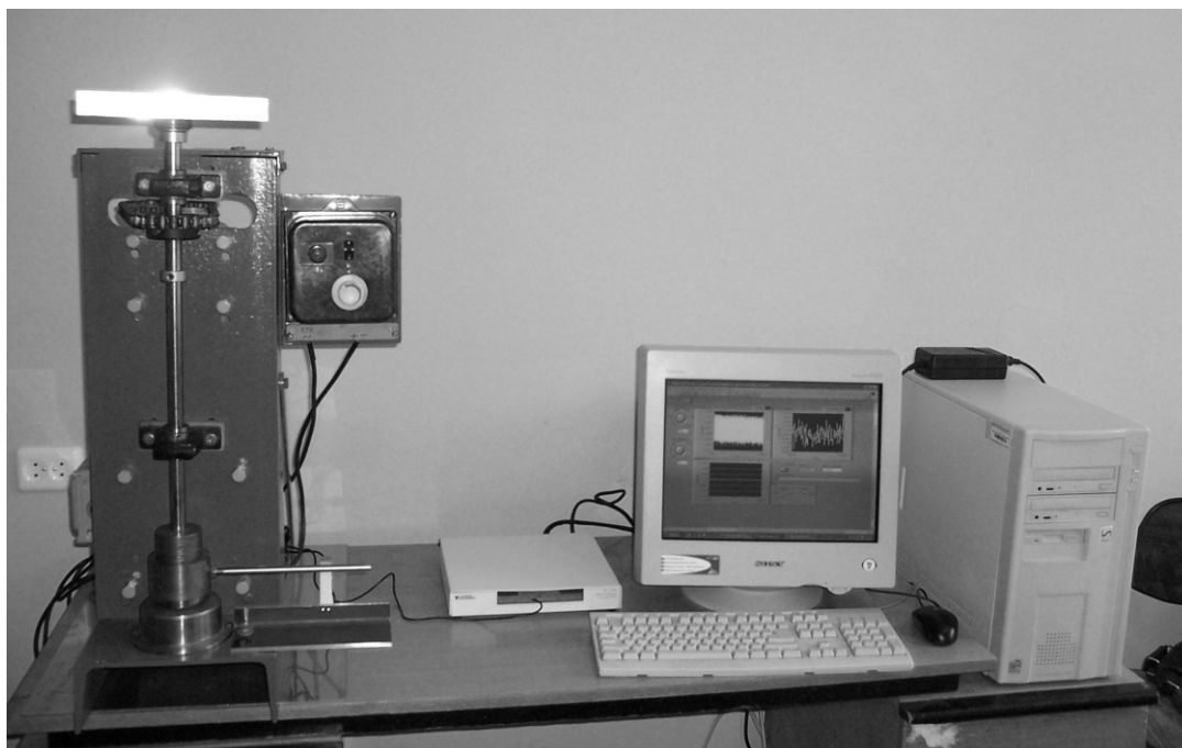
3.2 pav. Birių medžiagų šlyties tyrimų stendas paruoštas darbui
