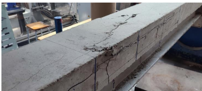
S3.2 pav. Kompozitinės 3 m sijos irtis dėl betono sugniuždymo grynojo lenkimo zonoje
