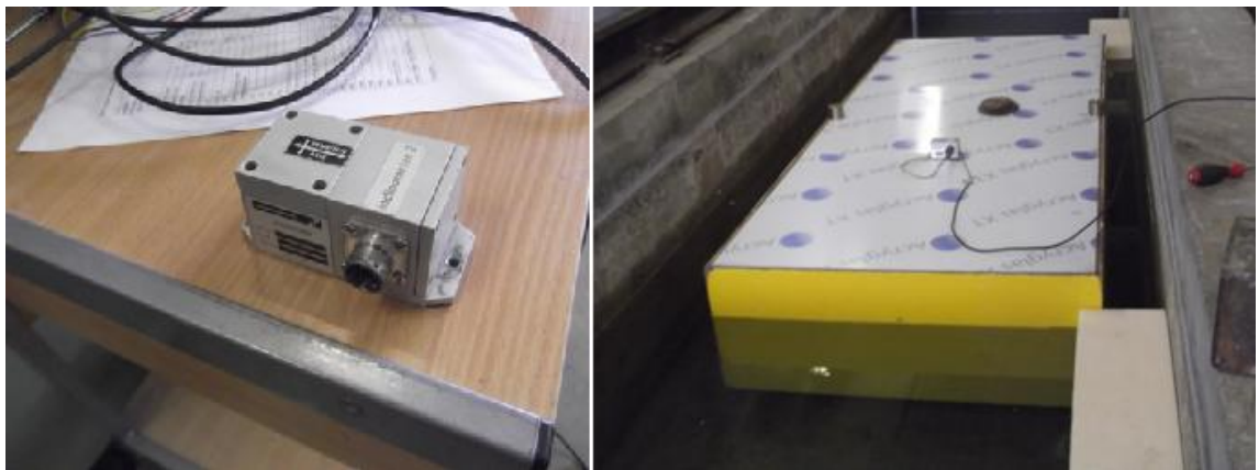
20 pav. Krenavimo bandymas atliekamas panaudojant inklinografą
