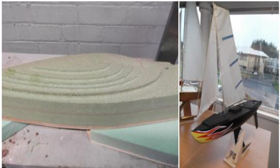
17 pav. (A) Automatizuotas modelio išpjovimas, (B) užbaigtas modelis
