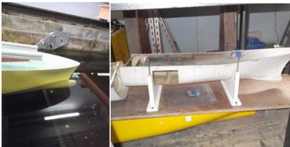
18 pav. Ant laivo modelių paviršių žymimos linijos - atitinkančios španhautus ir vaterlinijas
