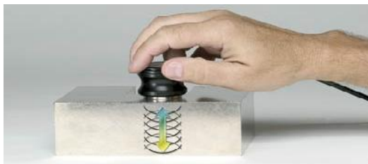
17 pav. Ultragarsinio storio matavimo veikimo principas [ http://ultrasonicthicknessgauge.org/ ]
