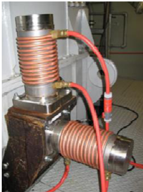
1.4.11 pav. Virpesių sukėlėjai sumontuoti ant danijos karo laivo reduktoriaus [13]
