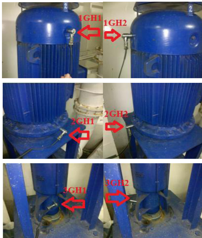
2.2.2 pav. ISO 10816 jutiklių padėtys vertikaliosioms rotacinėms mašinoms [6]
