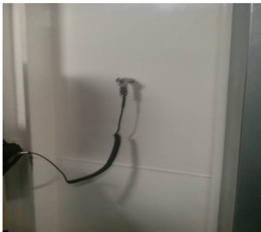
5.1 pav. Akselerometras pritvirtintas prie tiriamos konstrukcijos
