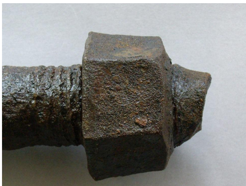
48 pav. Varžto veržlė pašalinus rūdžių sluoksnį
