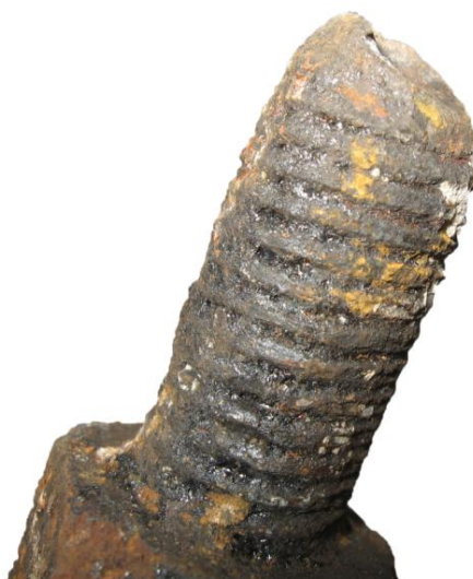
42 pav. Įsriegtos varžto dalies kūgiškumas
