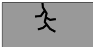
12 pav. Įtempių korozija (Šaltinis: Roberge R. P., 1999)
