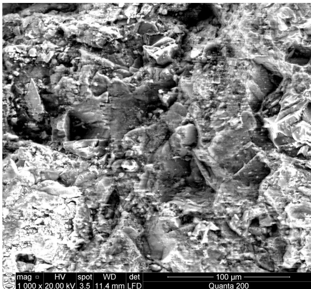
56 pav. Sukorodavusio paviršiaus vaizdas priartinus 1000 kartų
