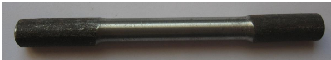
31 pav. Bandinys iš artilerijos aikštelių pakloto plieno Nr. 2
