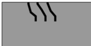
18 pav. Korozija dėl metalų nuovargio (Šaltinis: Roberge R. P., 1999)
