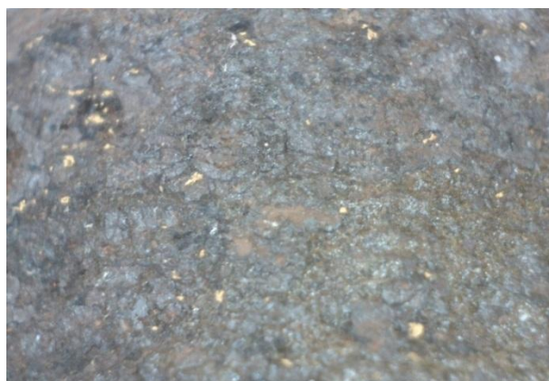
50 pav. Varžto paviršiaus vaizdas per mikroskopą priartinus apie 10 – 40 kartų
