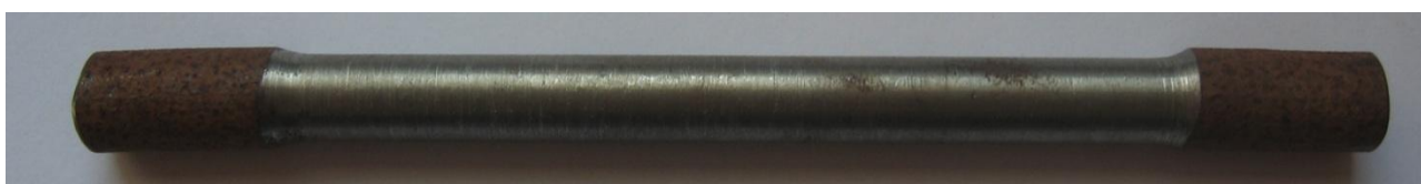
30 pav. Bandinys iš artilerijos aikštelių pakloto plieno Nr. 1
