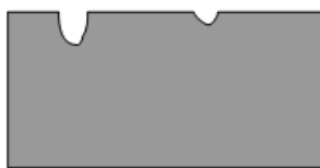
7 pav. Taškinė (pitingo) korozija (Šaltinis: Roberge R. P., 1999)
