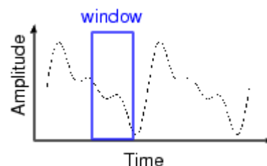
23 pav. Hamming langas naudojamas STFT
