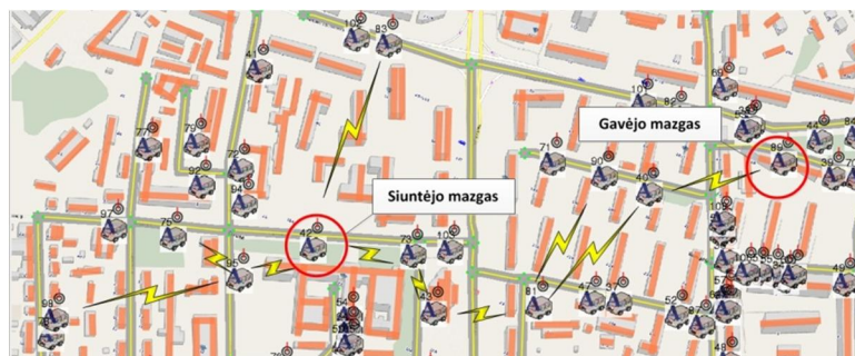
23 pav. Skirtingų ad-hoc maršrutizavimo protokolų efektyvumo eismo saugumo ir multimedija paslaugų teikimo VANET tinkle miesto sąlygomis tyrimo atlikimo schema
