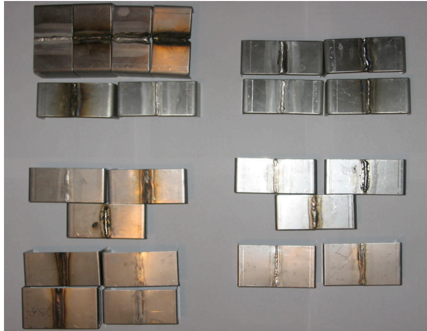
3.1.1 pav. Bandiniai su suvirintais sujungimais korozijos bei mikrostruktūros tyrimams
