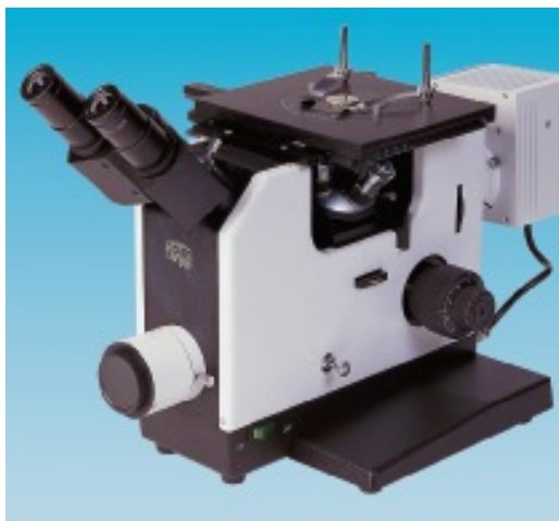
3.3.1 pav. Optinis mikroskopas (KRÜSS® MMB 2200)
