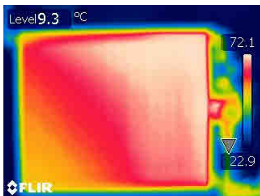
69 pav. Kaitintuvo galia 1000 W, greitis 3, a – po 4463 s, b – po 4578 s Vandens kiekis per radiatorių 9,83
