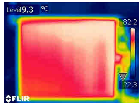
75 pav. Kaitintuvo galia 1250 W, greitis 3, a – po 5638 s, b – po 5748 s Vandens kiekis per radiatorių 9 l
