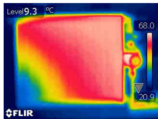
60 pav. Kaitintuvo galia 750 W, greitis 1, a – po 2497 s, b – po 2598 s Vandens kiekis per radiatorių 12,6 l
