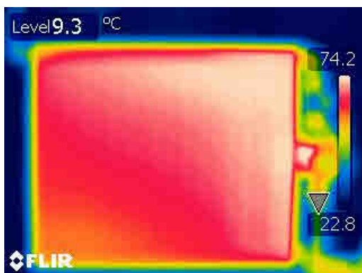
69 pav. Kaitintuvo galia 1000 W, greitis 3, a – po 4463 s, b – po 4578 s Vandens kiekis per radiatorių 9,83
