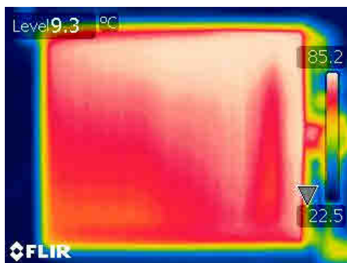
76 pav. Kaitintuvo galia 1500 W, greitis 1, a po 5851 s, b – po 5954 s Vandens kiekis per radiatorių 12,3 l
