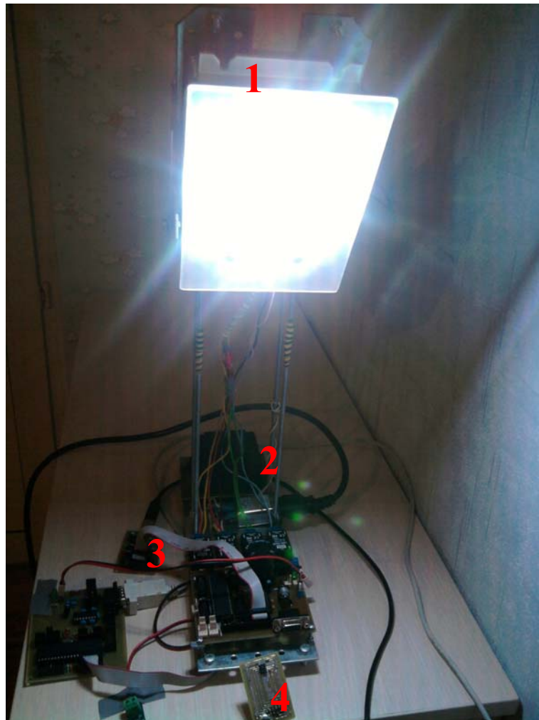
3.2. pav. Sukonstruoto RGBY šviestuvo ir jo maitinimo, išmaniojo valdymo ir grįžtamojo ryšio blokai. (1 – RGBY šviestuvai; 2 – RGBY šviestuvo maitinimo blokas; 3 – Išmaniojo valdymo blokas; 4- Spalvos jutiklis.)
