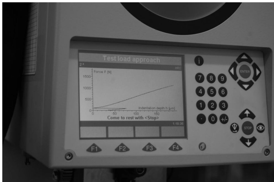
33 pav. Bandyuose naudota apkrova matoma skaitmeniniame Zhu 250 ekrane
