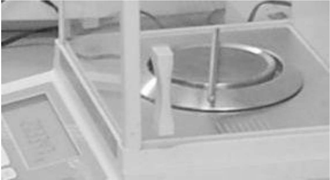
36 pav. Bandinių svėrimas KERN ABS 120 – 4 elektroninėmis svarstyklėmis
