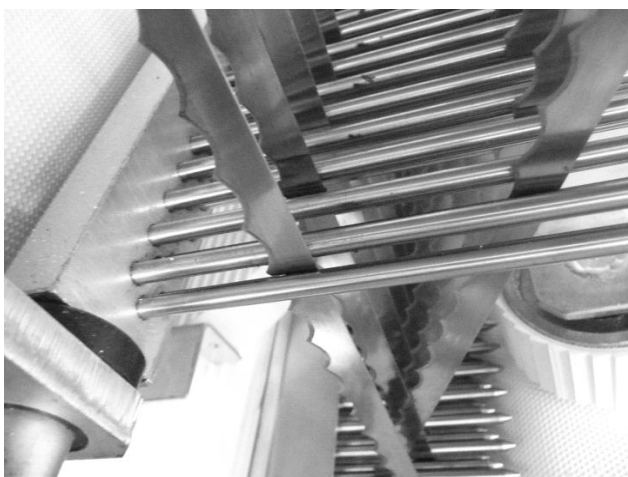
29 pav. Pjūklų ir kreipiančiųjų dilimo pora
