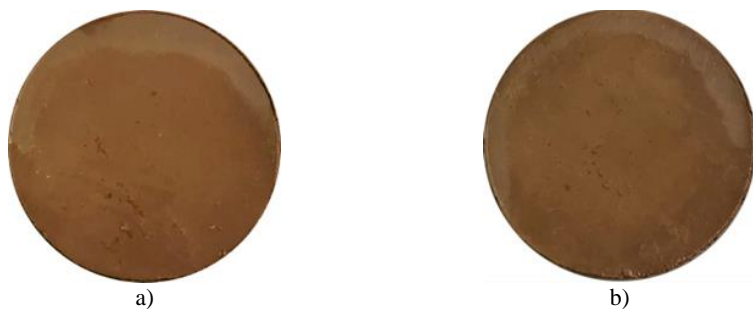
5S pav. Molio kompozito paviršius po vandens erozijos bandymo: a) RSH-2,5(3) kompozitas; b) RSH-2,5(5) kompozitas
