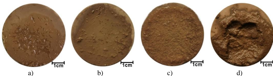
4S pav. Molio kompozito paviršius po vandens erozijos bandymo: a) kontrolinis molio kompozitas; b) SC-2,5 kompozitas; c) AC-2,5 kompozitas; d) CC-2,5 kompozitas
