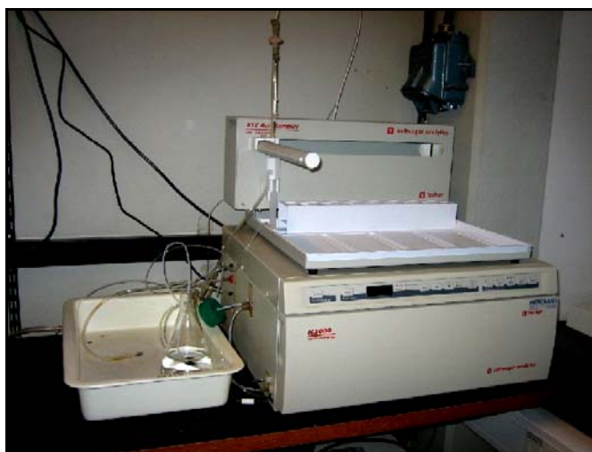
2.10 pav. Zellweger analytes firmos prietaisu IC5000 Ion chromatograph, XYZ autosampler ASX-500 Norvegijos gamtos mokslų universitete
