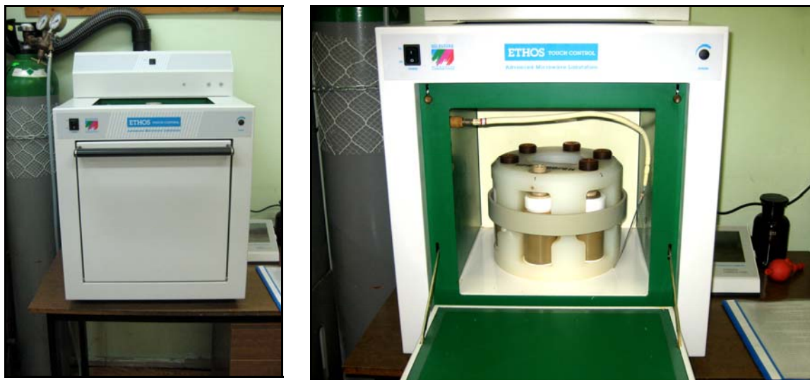
2.12 pav. Milestone firmos mineralizatorius ETHOS Vilniaus Gedimino technikos universiteto Aplinkos apsaugos instituto Aplinkos apsaugos ir darbo sąlygų laboratorijoje
