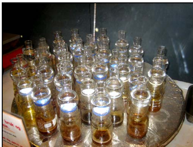
2.11 pav. Dirvožemio bandinių ruošimas sunkiųjų metalų bendrosioms koncentracijoms nustatyti, naudojant karališkąjį vandenį
