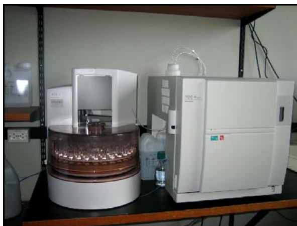
2.9 pav. Shimadzu firmos anglies analizatorius TOC-V CPN Norvegijos gamtos mokslų universitete
