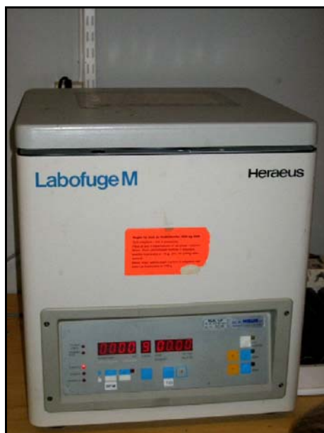
2.8 pav. LabofugeM , Heraeus (3000 apsisukimų per minutę) firmos centrifūga Norvegijos gamtos mokslų universitete
