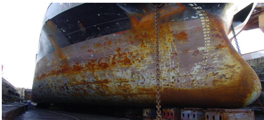
5 pav. Laivapriekis, pažeistas kavitacinės erozijos
