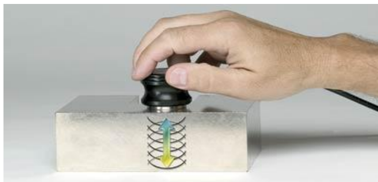
10 pav. Ultragarsinio stormačio veikimo principas [6]
