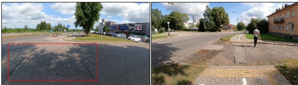
3.31 pav. Prastos būklės nelygi, duobėta dviračių trasos danga nuovažų ir sankryžų zonose
