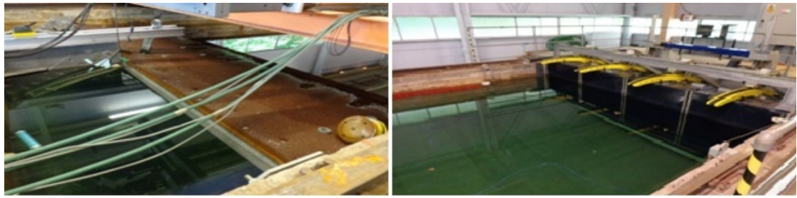
41 pav. a) bangų sugėrimo paplūdimys, b) bangų generatorius
