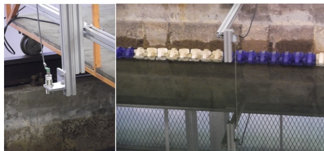
42 pav. bangografs ir jų išdėstymas
