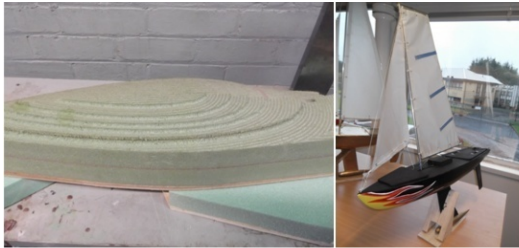
36 pav. Automatizuotas modelio išpjovimas
