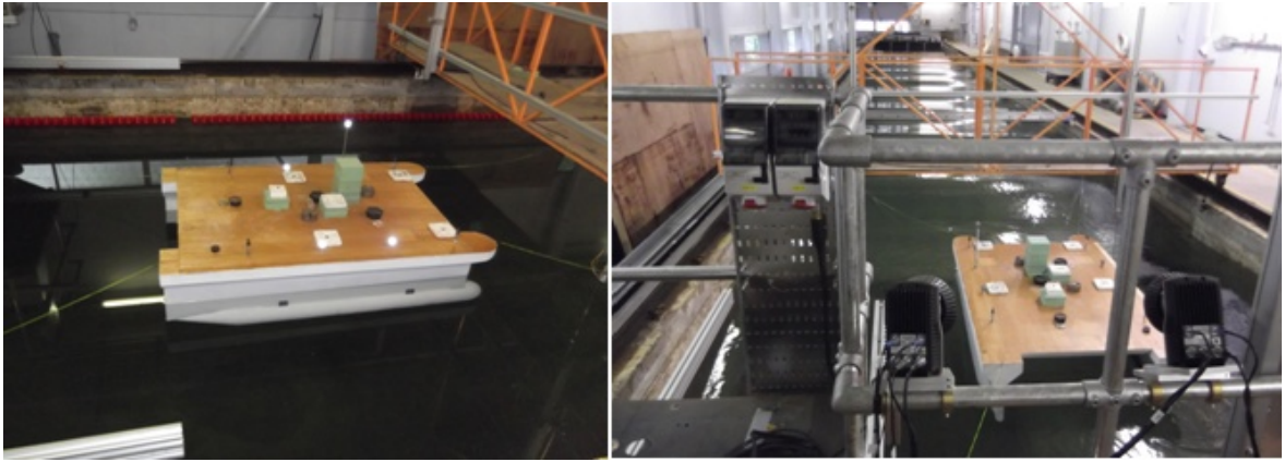
43 pav. Laivo supimosi matavimas
