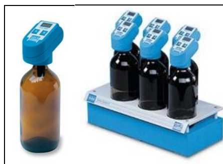
2.9 pav. VELP Scientifica firmos BDS sensorių sistema su magnetine maišykle (VELP Scientifica 2010)
