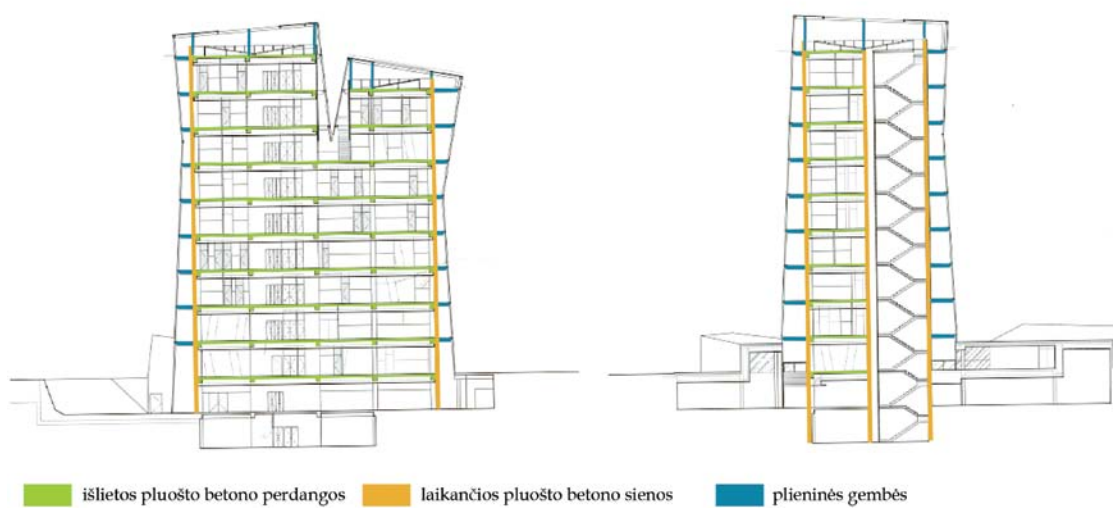
26 pav. Konstrukcinė pastato schema
